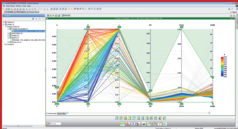
Per vagliare le soluzioni è disponibile, ad esempio, il grafo Parallel Coordinate. Le variabili di input e output selezionate sono mostrate verticalmente e ogni design è rappresentato da una poli-linea, che viene colorata in base al valore della variabile selezionata
